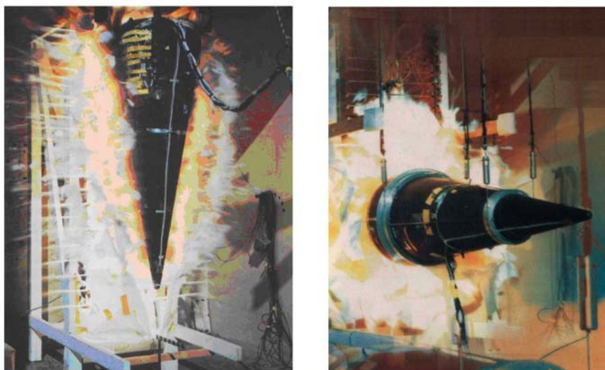
Рис. 2. Нагрузка взрывом слоя светочувствительного ВВ головных частей на установке LINE в Сандийской лаборатории.
