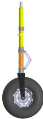
Рисунок 3. модель носовой стойки с многослойной заклёпанной вилкой
