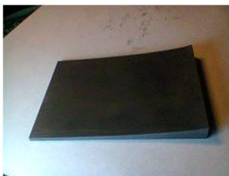
Рис. 4. Фотография изготовленной графитовой селективирующей пластины.
