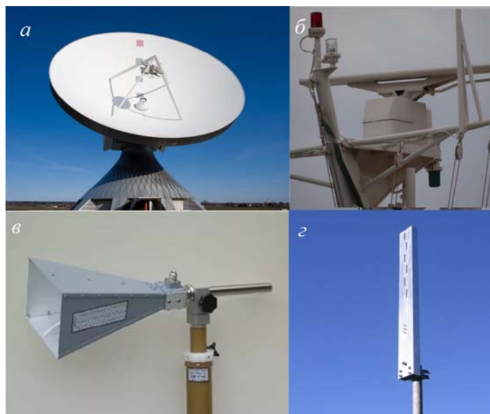
Рис.7. Типы антенн: а - зеркальные, б - линзовые, в – рупорные, г – щелевые
