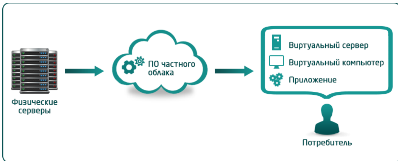
Рис.1. Общая схема частного облака
