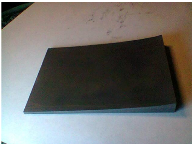
Рис 6. Фотография изготовленной графитовой селекционирующей пластины.
