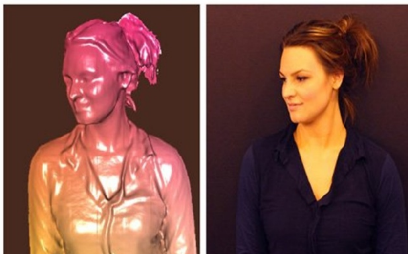
Рис. 4. Пример работы алгоритма Kinect Fusion.
