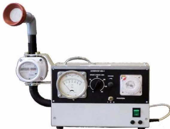
Рис.3. Общий вид аспиратора АВА-1
