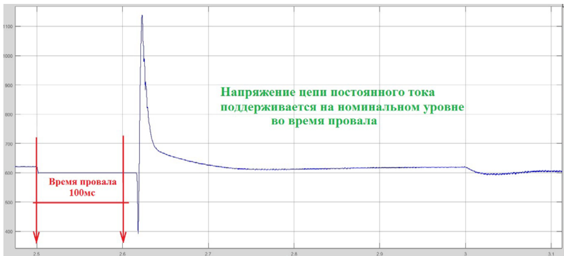
Рис. 13. Поддержание уровня напряжения в ЦПТ суперконденсатором
