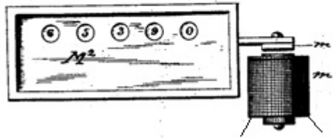
Рис. 1. Первый электрический счетчик Холлерита [8, с.2]
