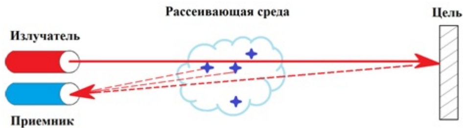
Рисунок 1. Принцип действия Lidar.
