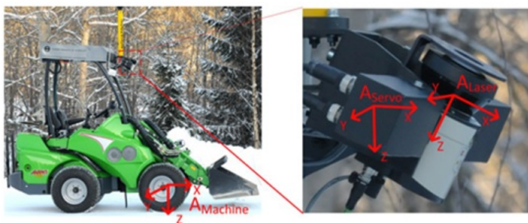
Рисунок 4. Применение 2D Lidar-датчиков и сервоприводов для получения 3D-изображения окружающего автономный погрузчик пространства.
