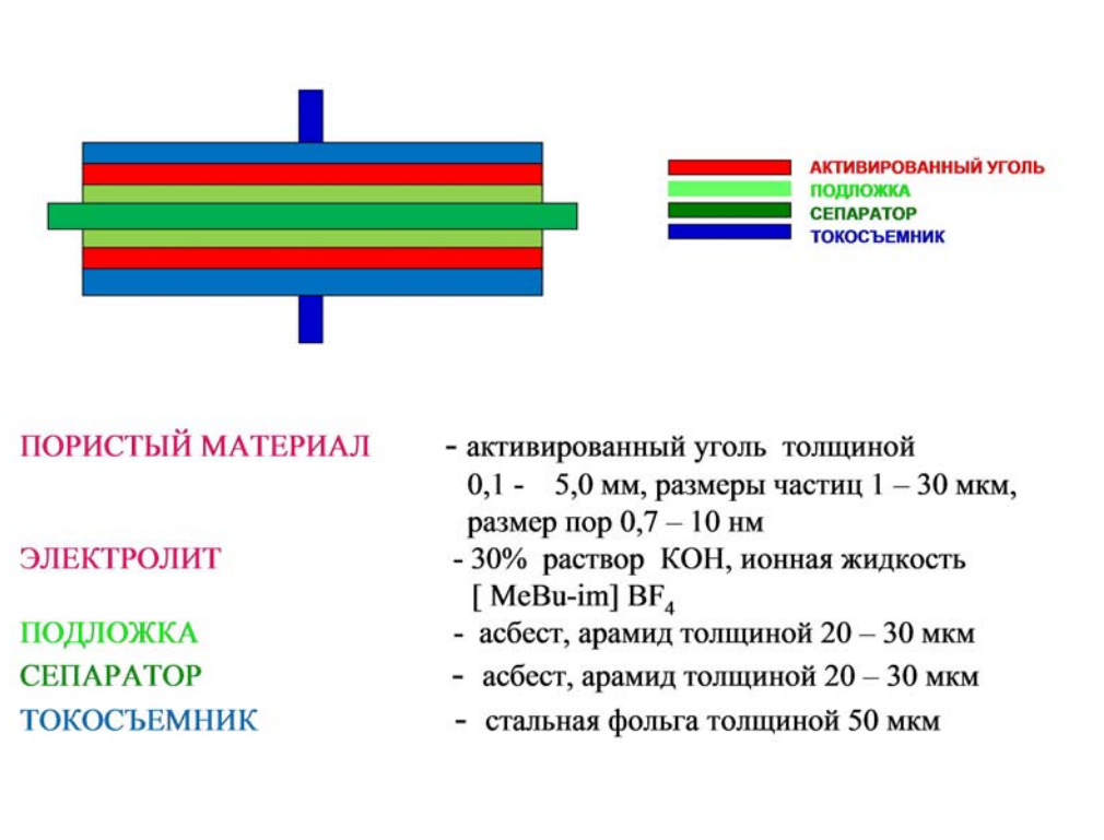
Рис. 8. Схема элементарного суперконденсатора
