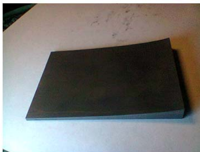
Рис. 2. Фотография изготовленной графитовой селектирующей пластины.
