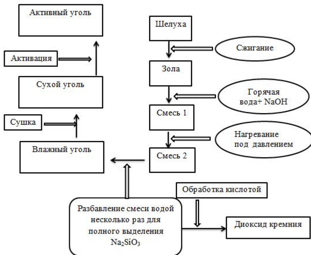
Рис. 1. Технологическая схема процесса переработки рисовой шелухи с получением активного угля и диоксида кремния
