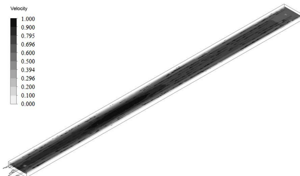
**Рисунок 4 – Распределение вектора относительной скорости в канале с жидким металлом**
