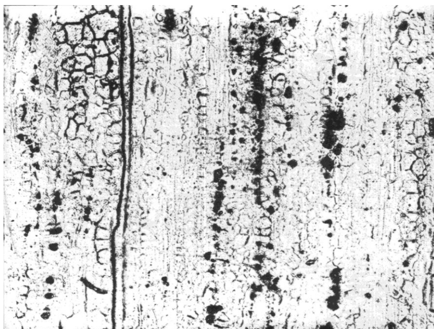
Рис. 36. Слабое откольное повреждение вязкого характера: ось образца – у, ширина изображения x_0 = 565 мкм.
