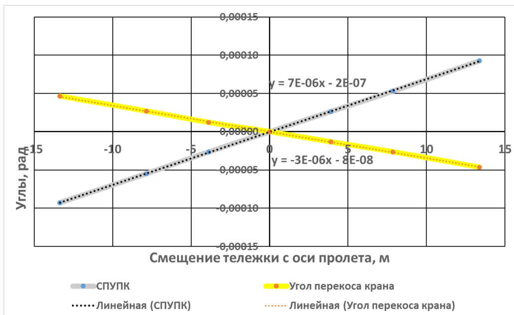
Рисунок 5 : Изменение СПУПК и угла перегиба крана при перегибах колес в пределах стандарта и начальных нулевых значениях рассматриваемых углов
