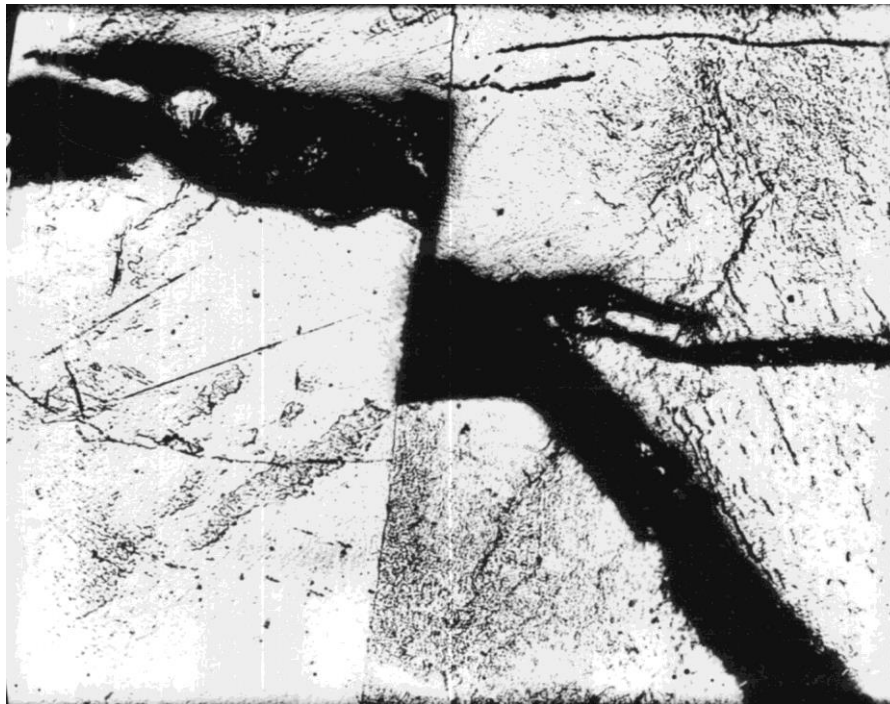
Рис. 13. Образование макротрещины в зоне намечающегося откола, x_0 = 590 мкм.
