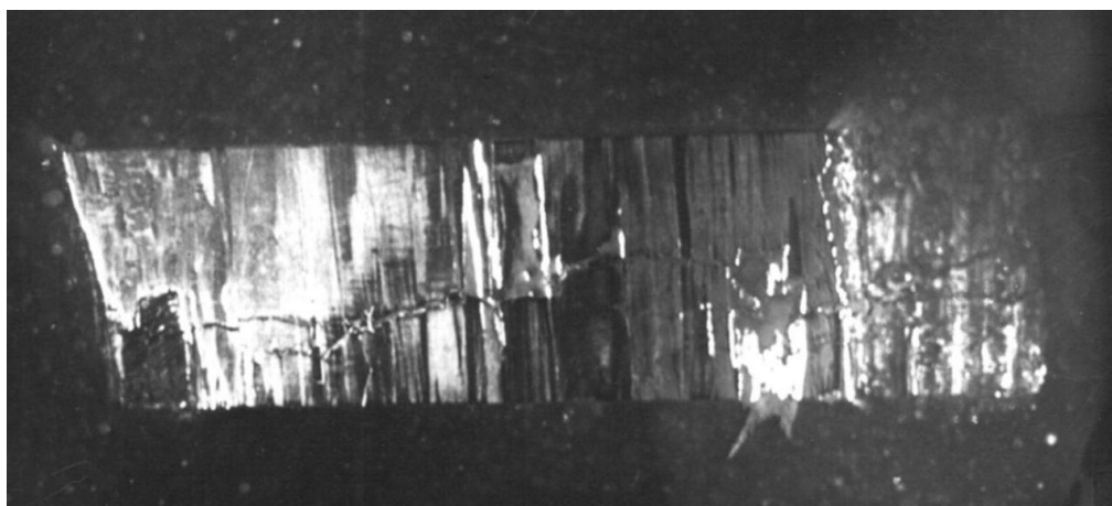
Рис. 6. Продольный излом разрушенного образца № 2 с магистральной откольной трещиной.
