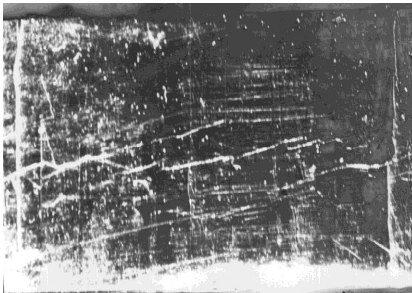
Рис. 8. Фрагмент шлифа продольного сечения образца № 3 с тонкими откольными трещинами.
