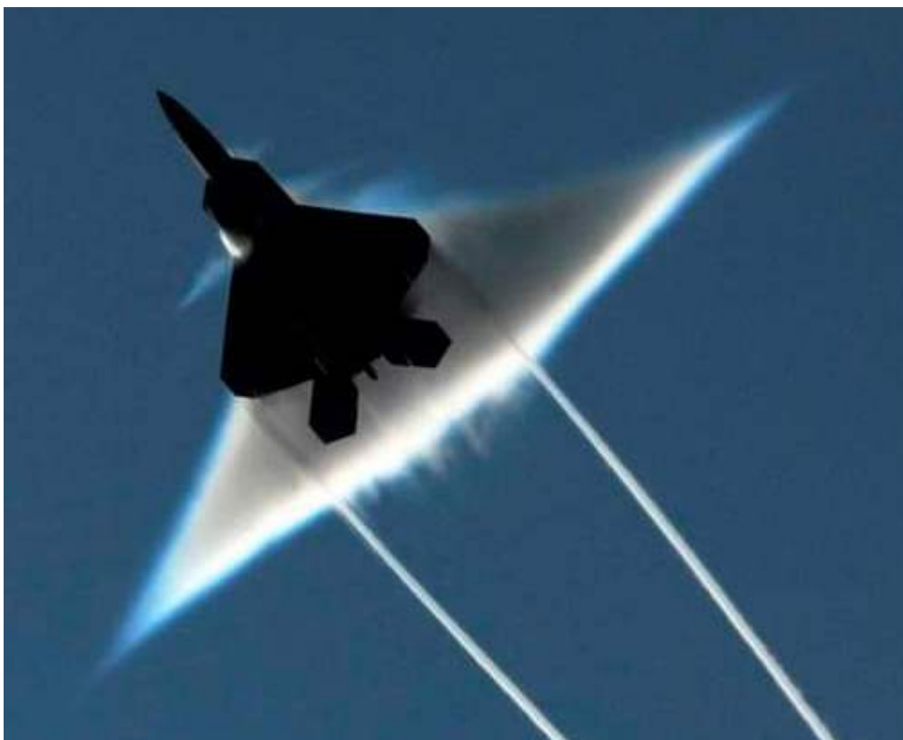
Рис. 10. Ударные волны во время преодоления звукового барьера и кавитация в результате заполнения воздухом пространства за ними.
