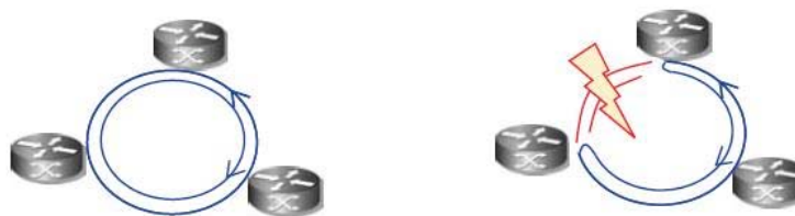
Рисунок 1- Защита от отказов при помощи колец обеспечивается как минимум 100% резервной пропускной способностью.
