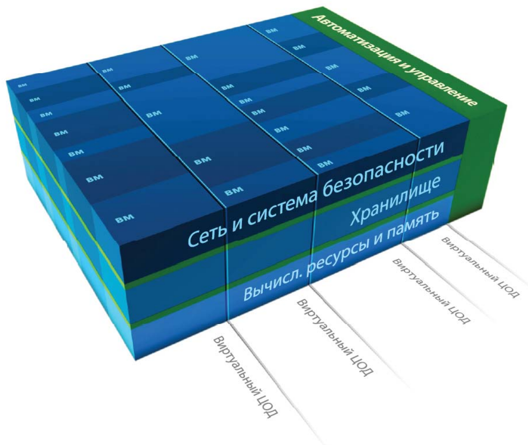
Рис.2. Общая структура программного ЦОДа
