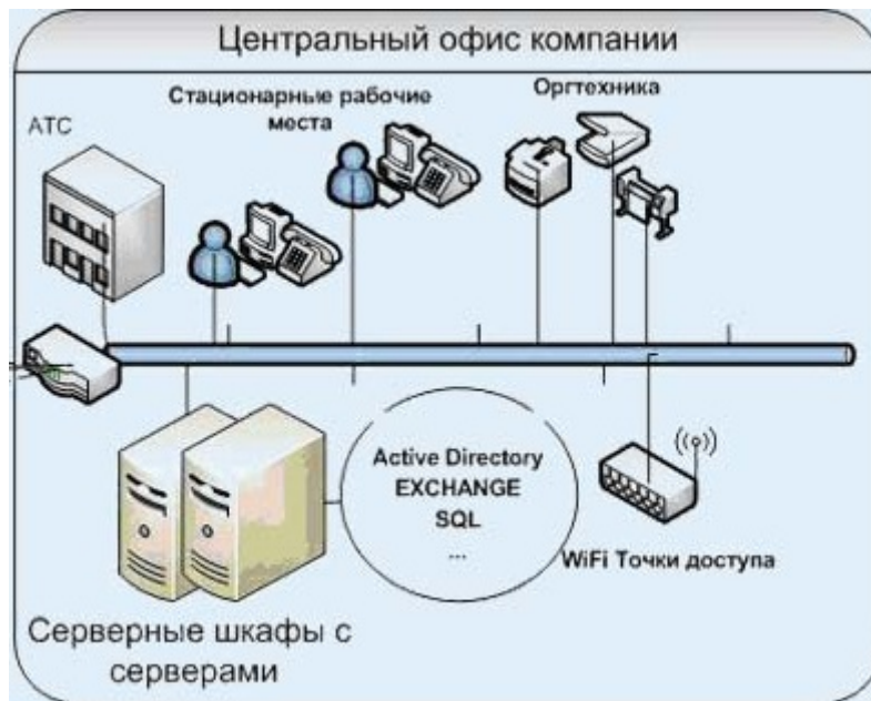
Рисунок 1. Структурная схема ИТ инфраструктуры в масштабах небольшого предприятия.
