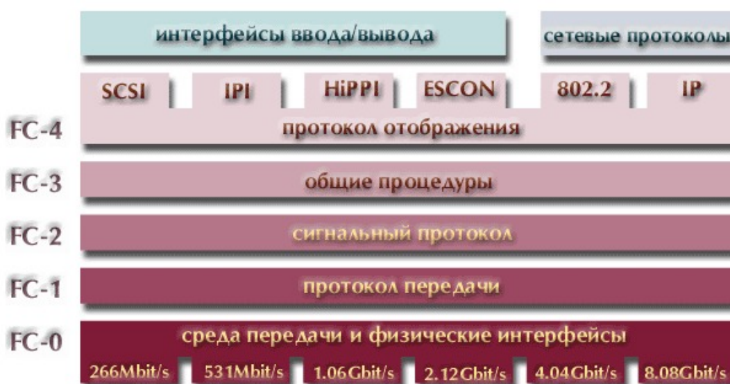
Рисунок 1. Схема пятиуровневой модели Fibre Channel.
