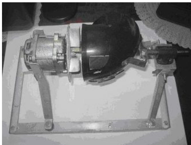
Рис. 8. Фото макетного образца безлопаточной турбины с доработанным ротором (обтекатель снят)
