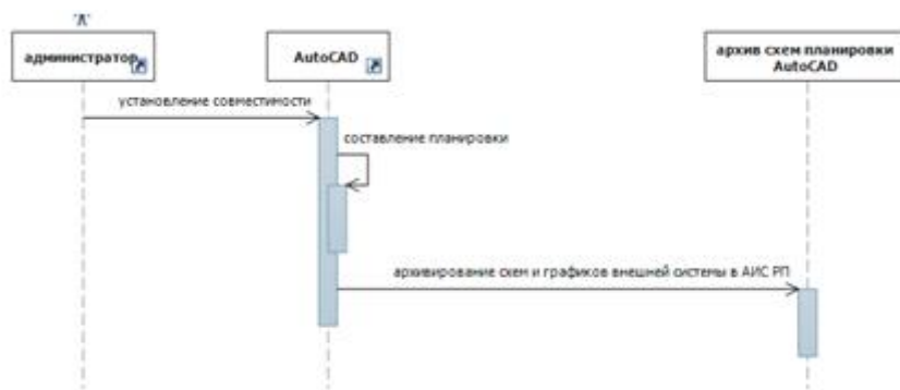
Рисунок 7 - Диаграмма последовательности «Обеспечение взаимодействия с внешней САПР AutoCAD»
