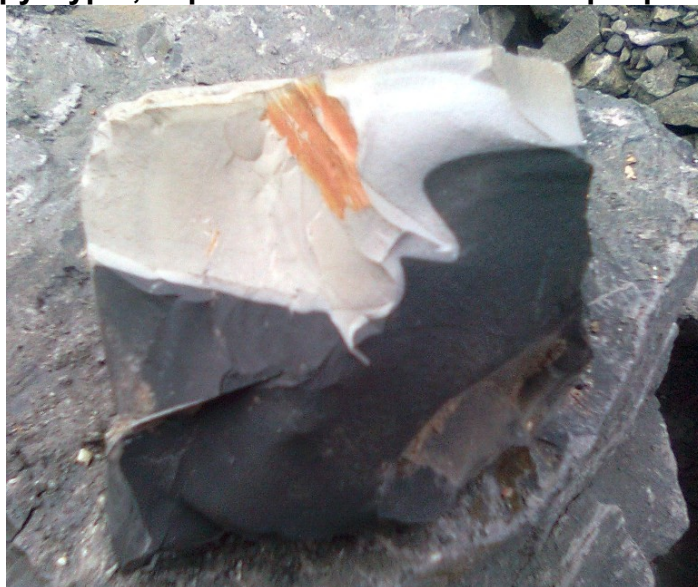
Рис 13. Потеря структуры, неровное сплавление алевроаргиллита и песчаника
