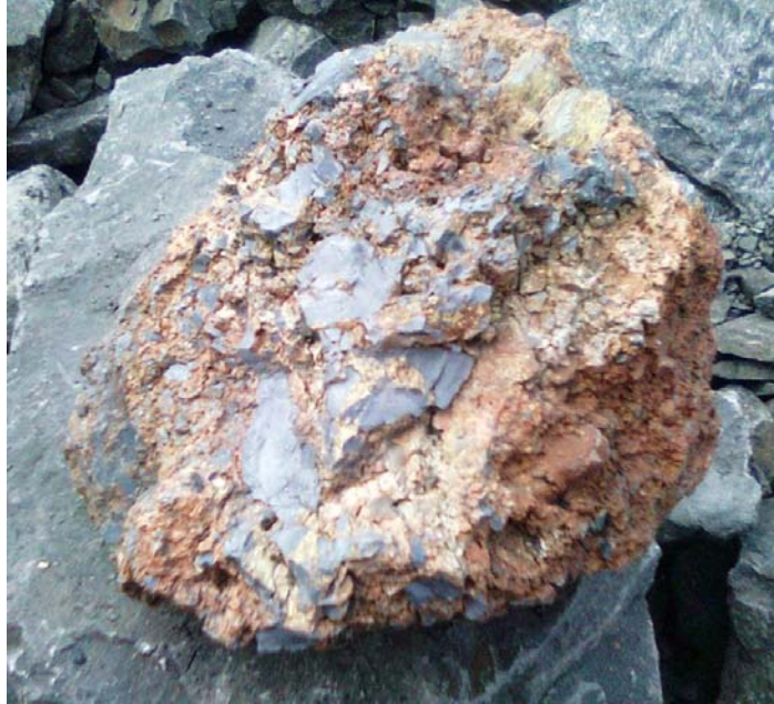
Рис 12. Горельник, термические изменения породы в зоне эндогенного пожара
