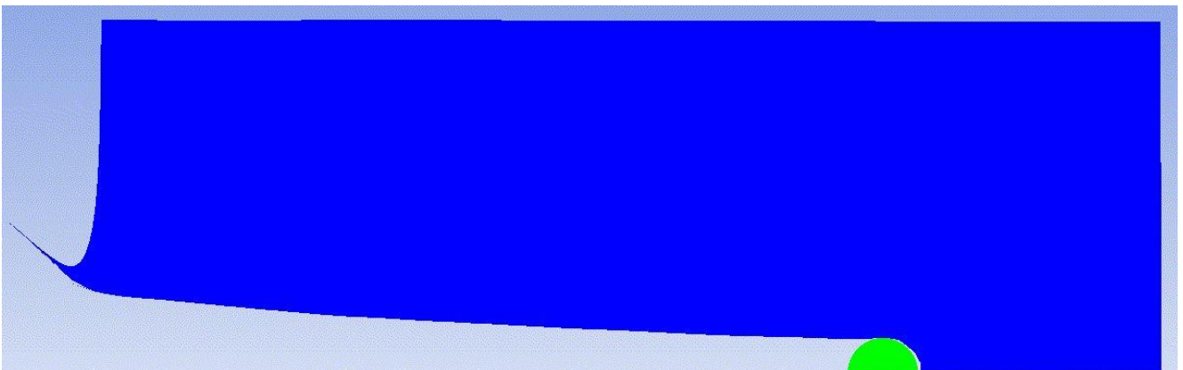
Рис. 11. Проникание недеформируемого ударника в преграду при скорости удара 1600 м/с.
