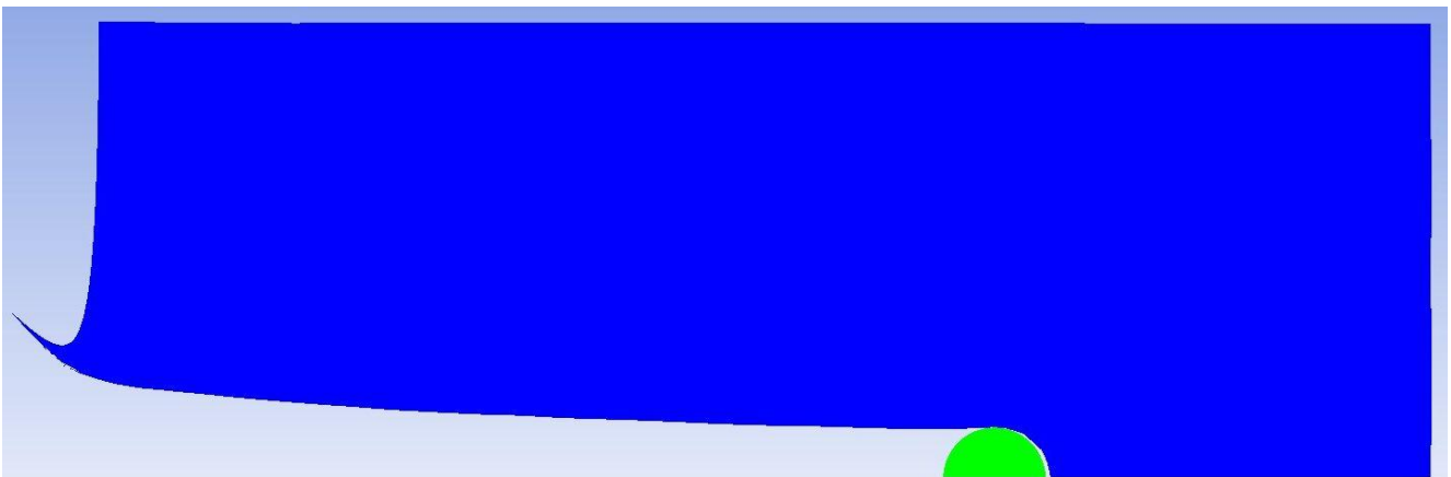
Рис. 8. Проникание недеформируемого ударника в преграду при скорости удара 1200 м/с.
