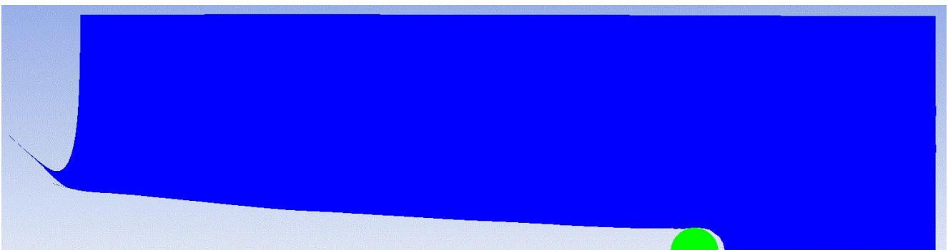
Рис. 14. . Проникание недеформируемого ударника в преграду при скорости удара 2000 м/с.
