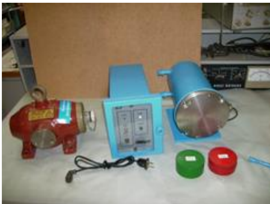
Рис. 1. Сигнализатор-индикатор уровня нефтяного кокса радиоизотопный.
