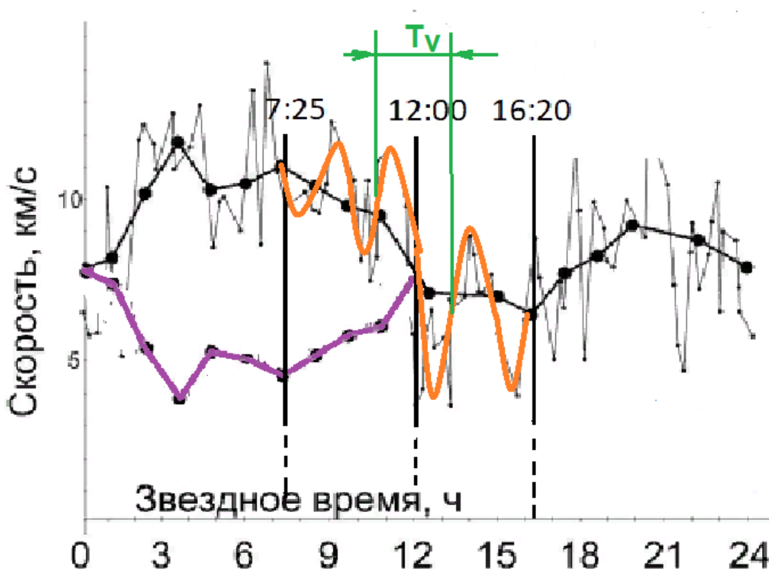
Рисунок 2. Определение периода биений от сравнения частот падающего на Землю и отраженного от неё солнечного света.
